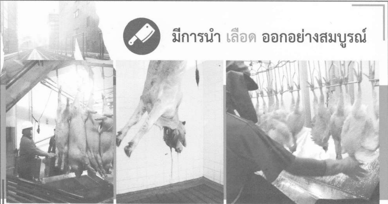
สุกรควรใช้เวลาไม่น้อยกว่า ๔ นาที โค-กระบือประมาณ ๕-๖ นาที และสัตว์ปีกไม่น้อยกว่า ๒ นาที
